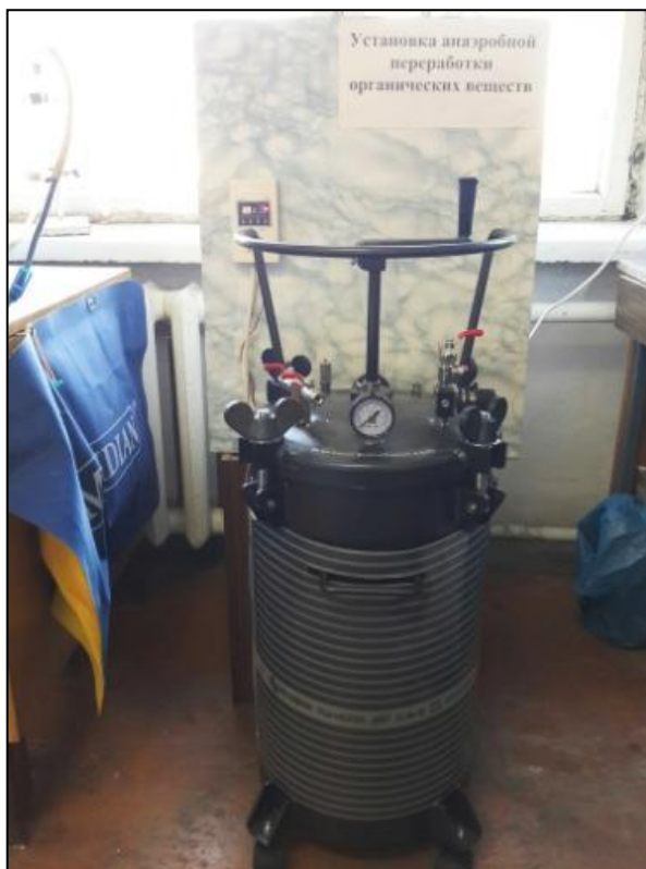
Рисунок 1. Внешний вид опытной установки анаэробного сбраживания обезвоженного избыточного активного ила
