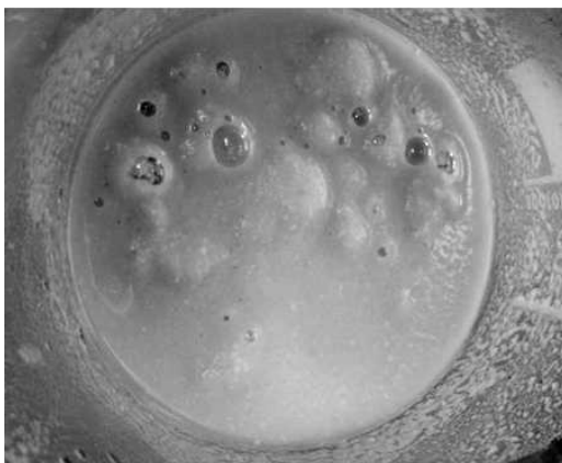
рис. 1 Внешний вид образца с конгломератами муки (образец с 20% овсяной муки, растворенный при температуре 20 °С)
