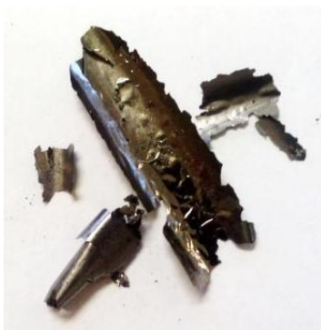
Рис. 2. Образец, полученный лабораторным методом на стенке кварцевой трубки
