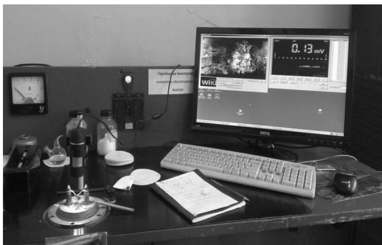
Рис.2 Лабораторный комплекс для определения температуры плавления сталеплавильных шлаков
