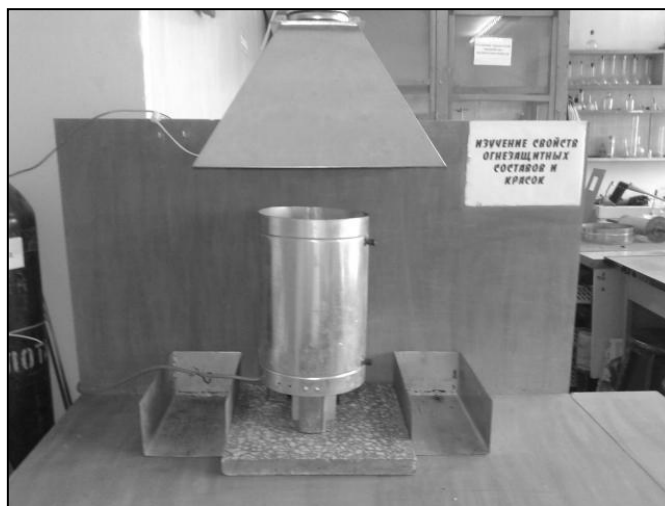
Рис. 1. Лабораторная установка по определению огнезащитных свойств материалов
