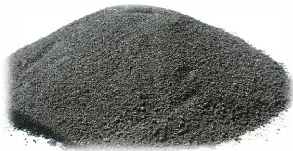
Рис. 1 Внешний вид буроугольного полукокса, полученного по технологии «Термококк»
