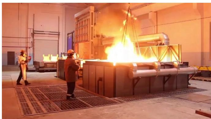
Рисунок 2 –Химико-термическое упрочнение поверхности
