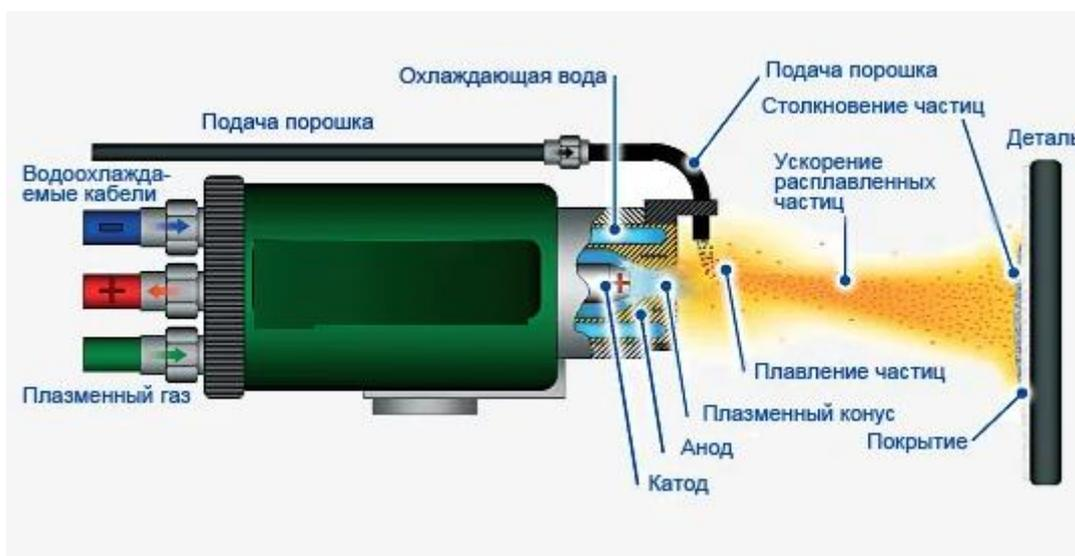
Рисунок 1 — Принципиальная схема нанесения атмосферно-плазменного покрытия
