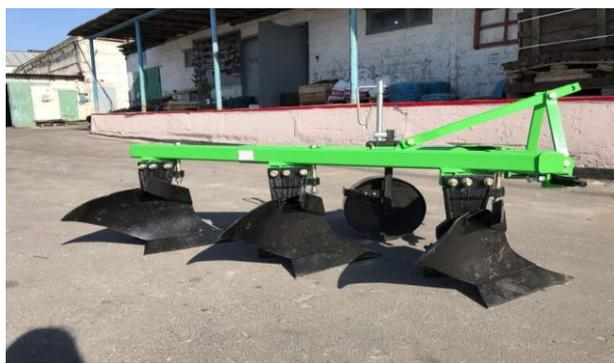
Рисунок 3 – Плуг с перьевыми отвалами и углоснимами
