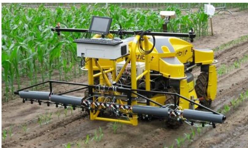
Рисунок 4 – Робот HortiBot
