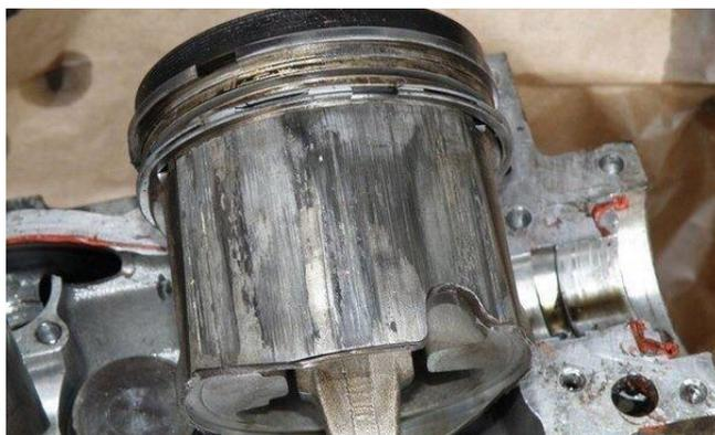
Рисунок 1– Пример износа на поршне
