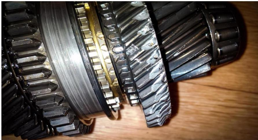
Рисунок 1 – Пример неисправности коробки передач
