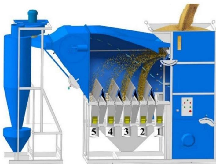
Рисунок 2 – Схема работы аэродинамического сепаратора
