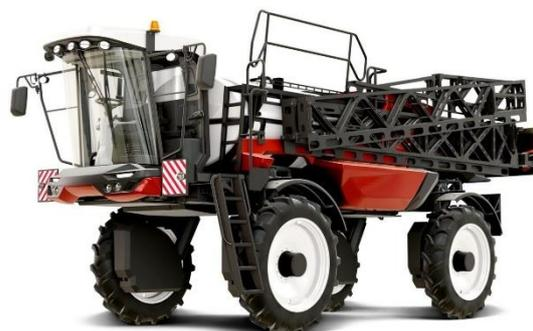
Рисунок 2 - Самоходный опрыскиватель RSM SPS – 3800 Sentinel (Россия)
