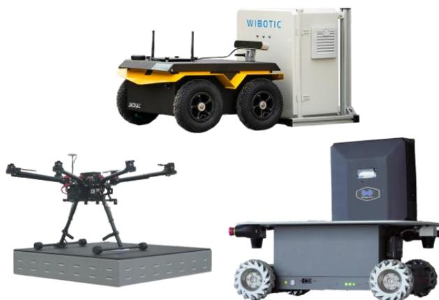
Рисунок 3 - Магнитно-резонансные станции зарядки для устройств от компании WiBotic [5]
