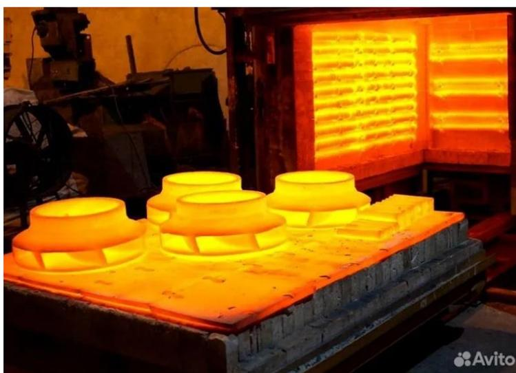
Рисунок 1 – Закалка рабочих органов в печи
