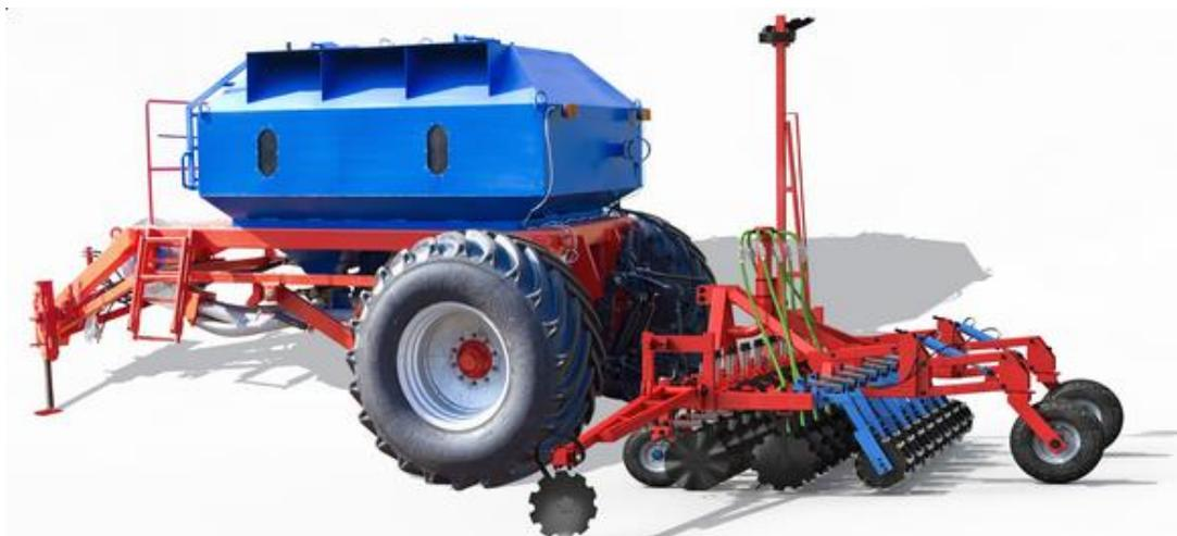
Рисунок 1 - Полосовой культиватор «Агиватор» со средством внесения удобрений ПВБ-8
