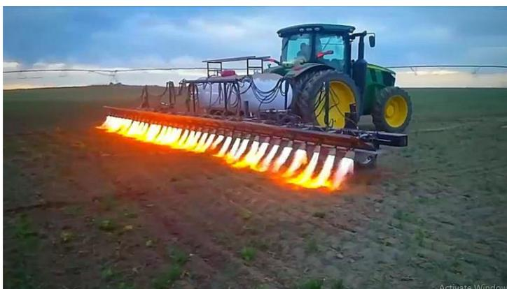
Рисунок 1 – Система обработки почвы огнем
