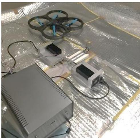
Рисунок 4 - Прототип микроволновой зарядки БПЛА из японского Университета Цукубы [6]
