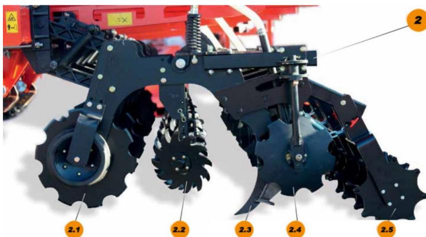
Рисунок 2 - Устройство рабочей секции полосового культиватора:
