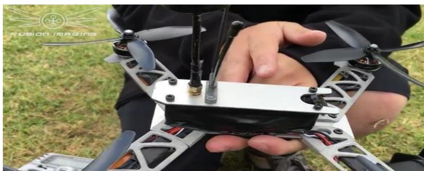
Рисунок 4 – Алюминиевый корпус и каркас БПЛА
