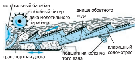
Рис. 129 Клавишный соломотряс (схема).
