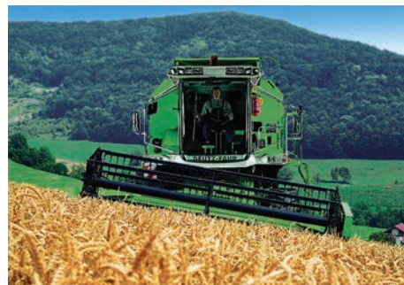
Рис. 128 При косейке с выравниванием машины на склоне соломотряс и решето остаются горизонтально до 20 градусов уклона склона.
