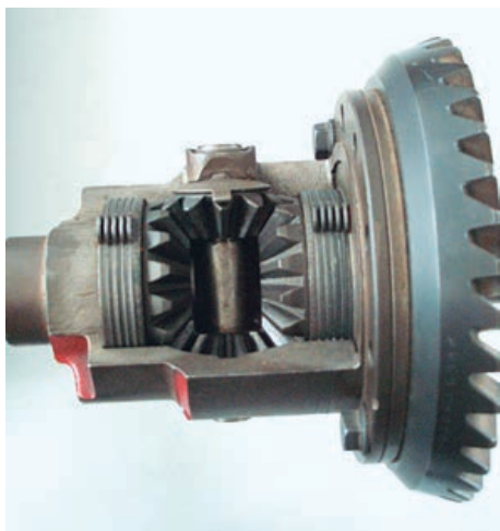
Рис. 202 При самоблокирующейся дифференциальной передаче блокирующее действие производится многодисковыми сцеплениями.
